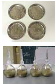
110°C炉乾燥による含水比測定 ピクノメーターによる粒子密度測定
